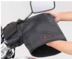
ミラー取付用穴にミラーを差し込み、取り付け位置を確認します。
