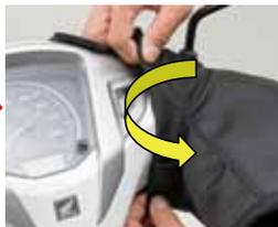
車両に合わせて、ハンドルカバーの取付部をPALSテープに沿って折り込み調整します。
