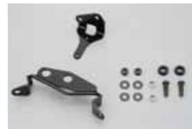
取付け幅45mmのタコメーターをボルトオンで取り付け可能です。防振設計のラバーマウントはメーターに優しく、エンジン横にタコメーターをリジッドマウントで取り付けて壊してしまった経験のある方でも安心してご使用いただけます。スチール製黒塗装仕上げ。
