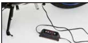
あらかじめ車体接続コードをバッテリーに取り付けておけば、カプラーオンで充電可能。※別売りの「バイク専用電源」と併用できます。
