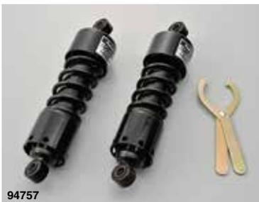
ローダウンしながらもストロークを約40mm確保し、スタイルと乗り心地を両立。最大荷重を確保し2人乗りにも対応。クロームメッキとブラックの2色をラインアップ。取付長280mmで約40mmローダウン。(ノーマル長:320mm) スプリングプリロード調整5段階。不等ピッチスプリングを採用。(パネレート:2.4・3.2kgf/mm) イニシャル調整工具付属。
