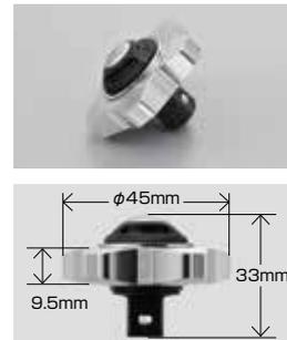
プッシュリリース付きソケット3/8インチ (9.5mm) 角に、外径φ45mm、厚さ9.5mmのアルミ削り出しハンドルが付いたグリップラチェット。スペースの少ない場所で作業がしやすいように全高33mmと薄型で、72ギヤの細かい回転が可能。
