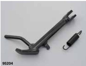
ローダウンリアショック280mm(94755/94757)を装着した際に必要となる、純正対比約-65mmのショートサイドスタンド。リア約40mmローダウンまたはリア40mm&フロント0~40mmローダウンの車両にベストマッチ。(この場合は傾き約10~15°になります)フロント&リア、またはリアのみのローダウン時に同時装着をおすすめいたします。スチール製でクロームメッキとブラックの2色をラインアップ。
