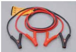
二輪車用のバッテリー端子に合わせ、クリップ部を小型化。クリップ同士のショートを防止する、絶縁スリーブを装備。携帯に便利なビニール製バッグも付属。適合バッテリー:6V・12V。定格:50A。長さ:1.5m。
