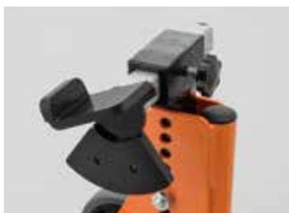
フロントフォーク下部から支えて持ち上げるタイプのフロントスタンド。カウルに干渉したりシステム下に穴が無いなど、フロントスタンドが使えない車両に最適です。リフトアップ面はカウンターウエイト(重り)によって常に上を向く構造なので簡単にリフトアップが可能。フロントを持ち上げて行なう整備に便利です。
