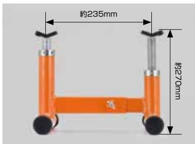
ビッグネイキッド等のダウンチューブ(フレーム)が通っている車両を直立にリフトアップするための商品です。左右高さ違いの設計でサイドスタンドをかけた状態から1人で安全に安定したリフトアップが可能。前輪のリフトアップと後輪のリフトアップにも対応し、通常のスタンドと違い、ステムやスイングアーム等に掛けないため作業幅も向上します。強風などの転倒対策にもオススメ。使わないときはコンパクトに収納可能。
