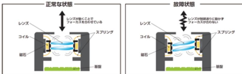
スマートフォンのカメラは、上下のスプリングによってフローティング状態に支持されているレンズを、電磁石の制御によって適宜移動させることでオートフォーカスを行なっています。
