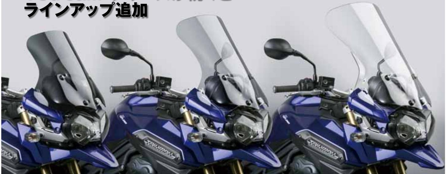
U.S.A. ナショナルサイクル社製のVStream®シリーズは空気抵抗の軽減だけでなく、独特な形状により走行風を整流して不快に感じる風の流れを軽減します。材質はポリカーボネイトで、形状によりQuantumコートかFMRコートが施されており、耐衝撃性、耐スクラッチ性が高められています。シリーズ全てがボルトオン取り付けで、余計な加工は必要ありません。取り付けに必要なものは全てパッケージされており、余分な買い足しも必要ありません。
