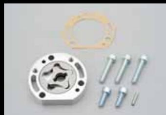
KEDO製のSR400/500用強化オイルポンプ。フィード側のオイルポンプを+50%強化し、シリンダーヘッドとクランクシャフトへのオイル潤滑を増やします。特にチューニング車両への取り付けは必須です。
