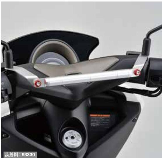
ボルトオンで簡単に取り付けできるステー付属のマルチマウントバー。メーター手前にストレートバーを配置することで様々な機器をマウント可能。スマートフォン、USB電源、ヘルメットホルダー、ドリンクホルダー、時計、コンビニック等アレンジは自由です。
