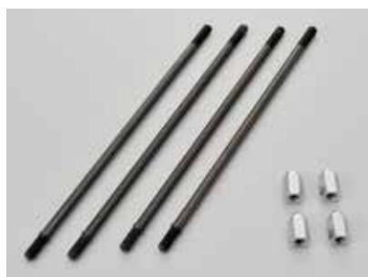
従来品(62144)より中間のストレート部分の直径をφ5.3→φ5.9に変更。約10%の断面積UPにより高剛性化を実現しました。
