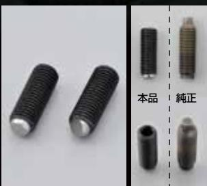
バルブ端面に摩耗やカジリの起こしやすいノーマルタペットスクリューの対策用としてご使用いただけます。先端がボール形状になっており、常にバルブを一定に押すことが可能なためバルブの耐久性UP。特に強化バルブスプリングを組んだチューニングエンジンには必須です。重量もノーマルから25%軽量化され、サージングの発生を軽減します。調整しやすい六角タイプ。
