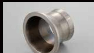
社外品(1重管)のエキゾーストパイプの入り口に取り付けます。内径を細く絞り流速を上げることでパワーUPを実現します。
