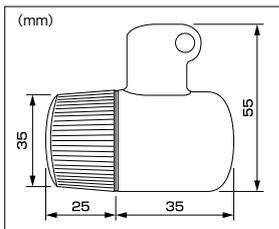
アルミダイキャストボディのスモールウインカーセット。12V23W/バルブ付属。2個1セット。
