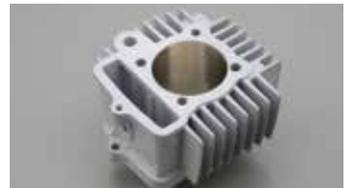
φ54は軽量で放熱性に優れたセラミックコーティングシリンダーを採用。φ52は放熱性に優れたアルミシリンダーに、スカート部の強度確保のため铸铁スリーブを採用。
