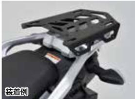
デザインされたウイング形状のアルミトッププレートと、車種専用取付フィッティングで、荷物を積載していない状態でも車体のフォルムを損なわないリアキャリア。
