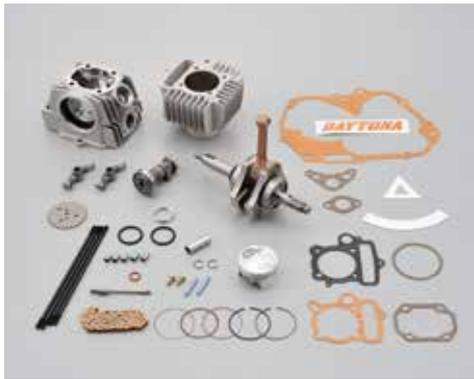
最大排気量の124.8ccは低回転から分厚いトルクを発生、回さずに楽しめ、かつSPクランクの採用で低振動を実現したツ어링に最適エンジンです。耐久性を重視するため、低めの圧縮比(10.8:1)、低回転のトルク重視のカムプロフィール、高耐久のメッキシリンダーを採用しています。圧縮比を10.5:1⇒10.8:1にアップし全域で性能向上しました(当社比)。
