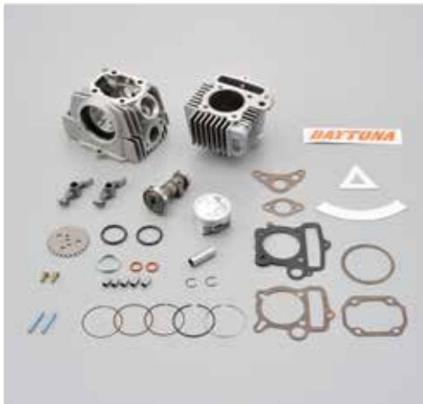
リーズナブルで性能、耐久性に優れたシリンダーヘッド付ボアアップキット。IN/EXのポート形状を適正化、圧縮比10.7:1⇒11.0:1にアップし全域で性能向上(当社比)。ノーマル比で3~4倍のパワーアップを果たします。シリンダーヘッドにDAYTONAロゴをレーザーマーキング。マニホールド取付部の高さを下げることで、従来は取り付けできなかったYD24/28キャブレターも装着可能になりました。
