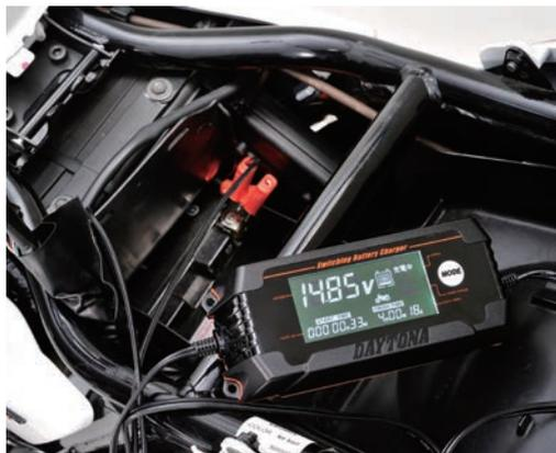
電圧テスターとして使用可能。本体はIP65<sup>\*1</sup>相当の防滴・防塵仕様。車体接続ハーネス付属<sup>\*2</sup>。二輪自動車から四輪自動車(普通車まで)の充電可能<sup>\*3</sup>。バッテリーに充電器を接続した際に、バッテリーの状態を判断し、最大6工程の充電を行ないます。充電後は、バッテリー電圧が安定したところで正確に判定を行ないます。自動で充電をストップ。サルフェーション除去機能付き。壁掛け用ホール付き。工具箱や自宅ガレージに!!本体ケースに取付穴を4か所配置<sup>\*4</sup>。
