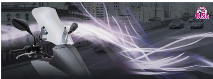
小さく跳ね上がったスクリーン上端のスポイラーが、正面からの風を上部へ送り、体への風圧を軽減。ウインドシールド本体は、高い透明度と耐久性を両立した3mm厚ポリカーボネート製。同厚の亚克力に対し約30倍の強度を誇る素材にはハードコート処理を施し、耐傷性も高めました。ウインドシールドの角度調節(約10度)が可能な車種専用の取付ステー付き。Made in Japan.
