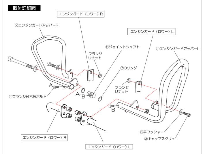
※詳細図のエンジンガード(ロワー)は分かりやすいように取り付け部のみ分解して記載しており、本来の商品状態と異なります。
