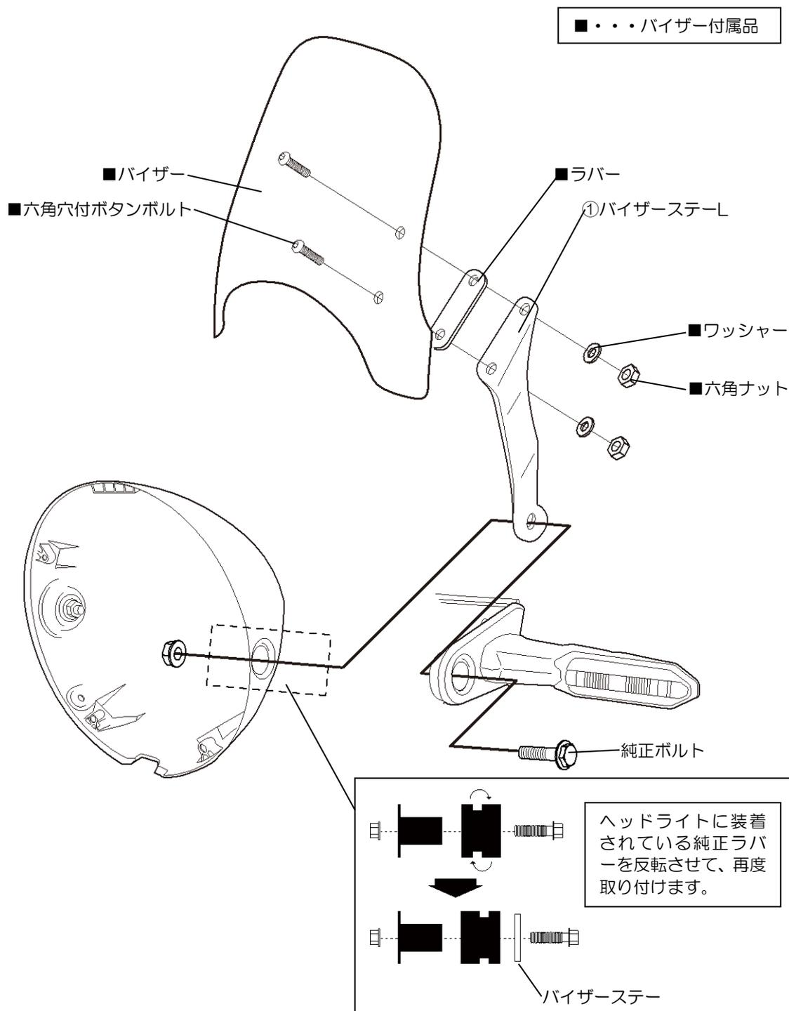
3. 工程2で仮組みしたバイザーを①②バイザーステーに本締めします。
