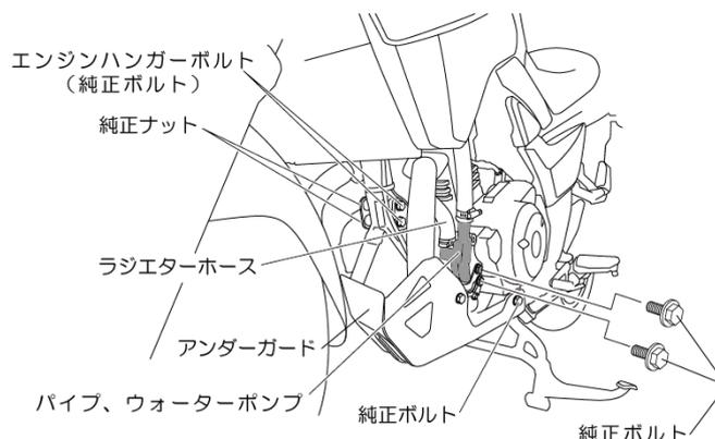
4. 手順3で挿し込まれた③キャップスクリュ M10X145 の逆側から⑤カラー-B (2ヶ)、純正ナット (2ヶ) を使用して①エンジンガードL (前側) を仮止めします。
