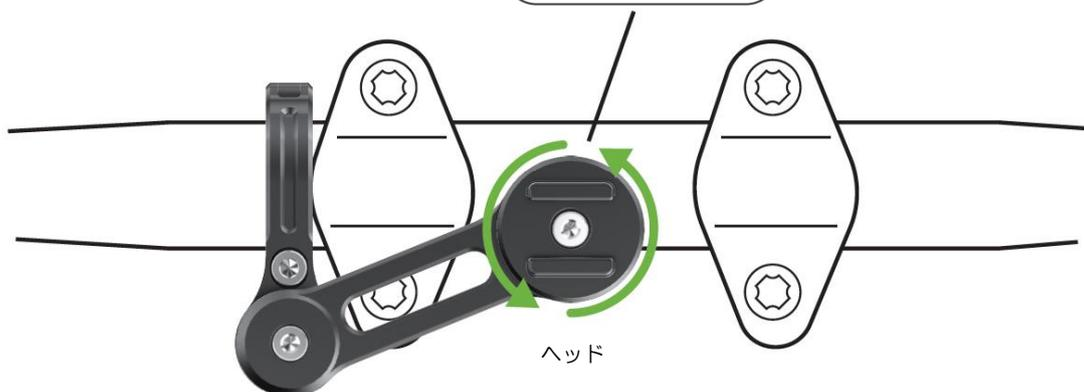
※ アームを取り外しマウントに直接ヘッドを使用する場合、スプロケットアダプターを使用します。
