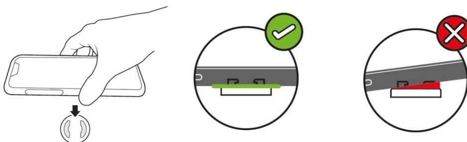
90度回転させて取り付けします。マウントとの緩み外れがないことを確認してください。
