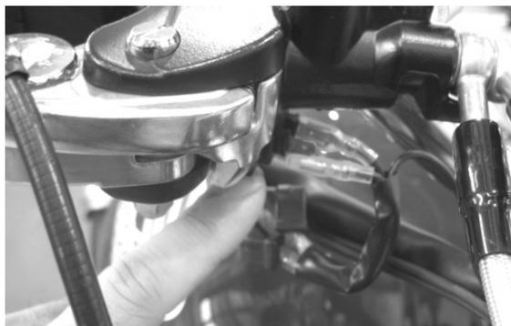
テスターを使用し、イグニッションキーONの時だけ 12V 以上の電圧が出力されている配線を使用する。2 極の端子のうち片側は 12V が出力されていませんのでご注意ください。接続には付属の⑤結線コネクタなどを利用してください。
