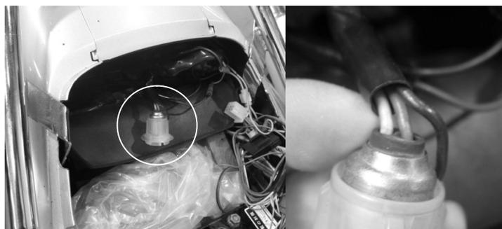
テスターを使用し、イグニッションキーONの時だけ 12V 以上の電圧が出力されている配線を利用する。ブレーキランプの線に接続をするとブレーキ作動時のみしか電気が流れませんのでご注意ください。接続には付属の結線コネクタなどを利用してください。
