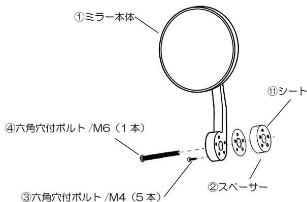
08. 左右ミラーを仮組したら乗車して後方が確認できる位置に調整します。
