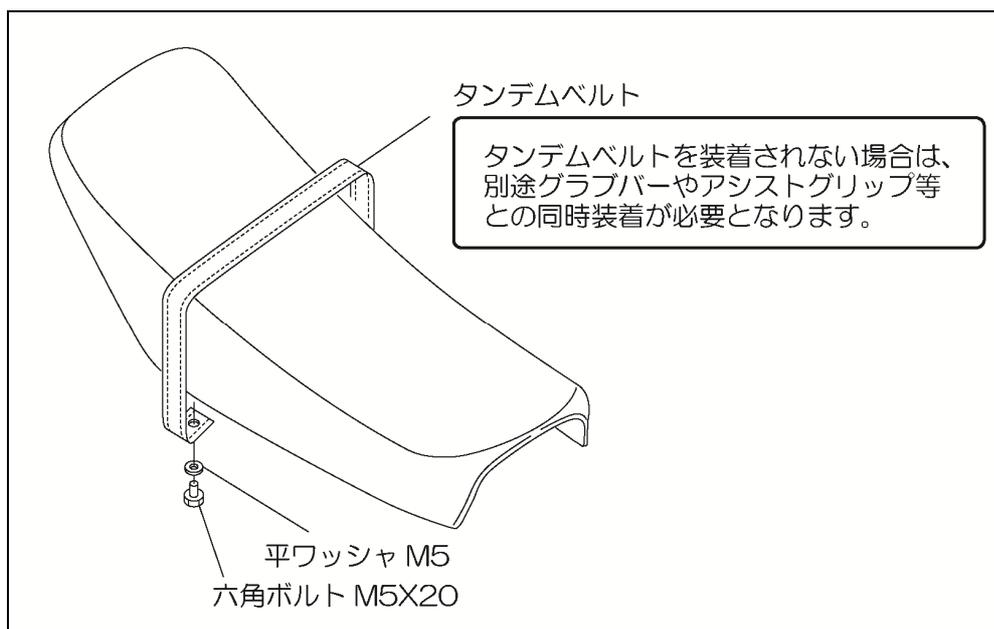
11. ①シートASSYを車体に乗せ、純正シートボルトにて固定します。
