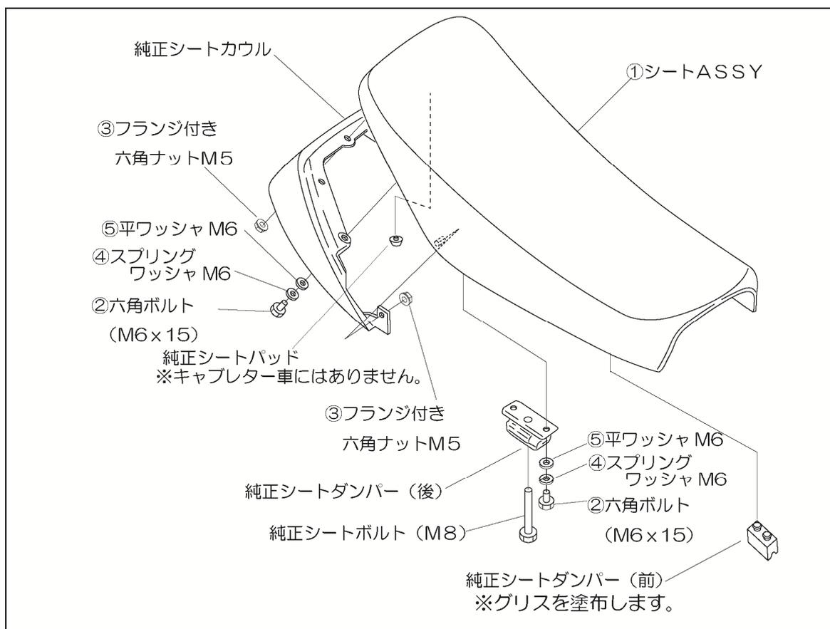
10. 別売のタンデムベルトを装着する場合は①シートASSYに、タンデムベルトを六角ボルト M5×20 (2本)、平ワッシャ M5 (2個) にて取り付けます。
