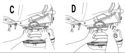
④キーを反時計回りに回し、ロックします。ロックをしたら、バッグ<u>上側</u>のツメが図Eの状態になっているか確認して下さい。 ※キーでロックをしなくてもバッグはバッグサポートに固定されてしまいますので、ロックのし忘れには十分注意して下さい。 い。
