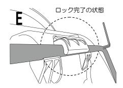
⑤装着が完了したら、サイドバッグが確実に固定できているかの確認をしてください。前後、左右、上下に動かして確実に 固定できているか入念に確認してください。
