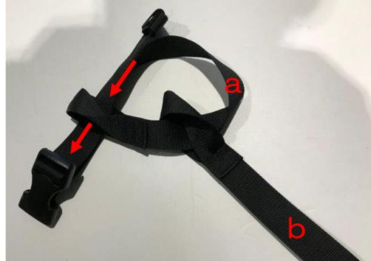
6：シートバッグの取り付け（4箇所）をしたら前方のベルトから調整を行い、本締めします。
