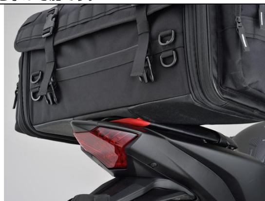
3：②固定ベルト(オス側)を使い、ステップや荷掛けフックなど固定強度の確保できる場所へ固定します。
