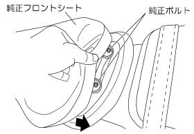
純正ボルト取り外し後、 後ろにスライドさせて取り外します。
