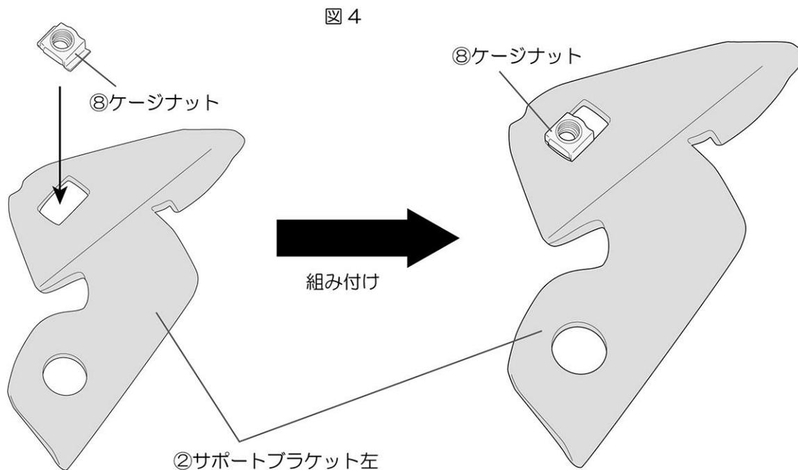
04. 手順 3 で組み立てた②サポートブラケット左右を車両に取り付けます。
