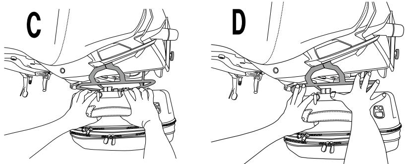
④キーを反時計回りに回し、ロックします。ロックをしたら、バッグ上側のツメが図Eの状態になっているか確認してください。
