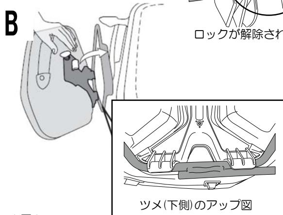
③サイドバッグ上側のツメをバッグサポートへ固定します。※図C
