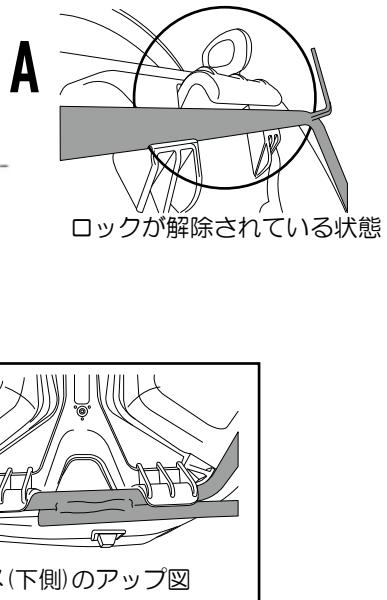
②サイドバッグ下側のツメをバッグサポートへセットします。※図B
