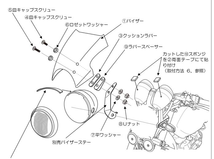
映り込みが気になる場合、カットした残りの⑩スポンジをヘッドライト上部に②両面テープにて貼り付けてバイザーとの隙間を埋めてください。
