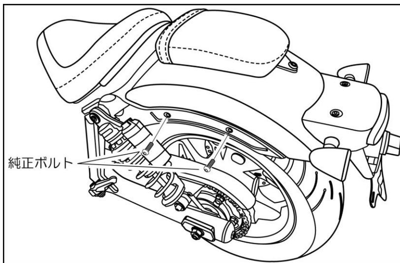
2. ①サドルバックサポートと純正シートフレームの間に②スペーサー/フロント、③スペーサー/リアを挟み④六角穴付きボルト M8×25（2本）を規定トルクで締め付けてください。
