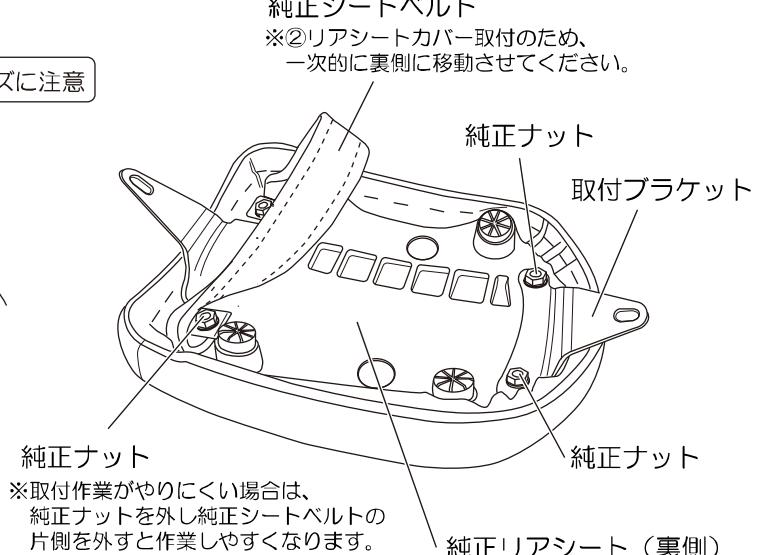
3. 純正タンデムシートに①シートカバー被せた後、左右連結のベルトを仮止めします。絞り用のコードを少し引き、①フロントシートカバーが純正シートから外れないように仮止めします。
