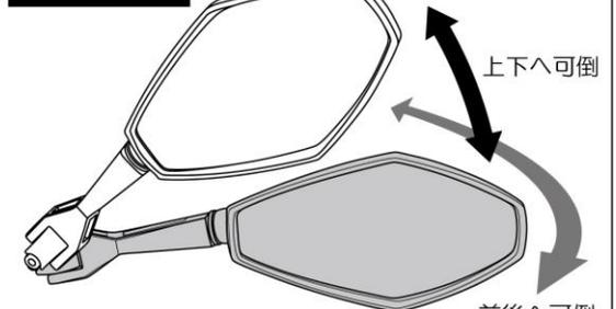
※ミラーを仮組み状態にして、乗車時に後方が十分に確認できる位置へミラーを調整します。
