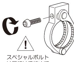
ボルトがまっすぐ挿入固定され、クランプ全体が動かず固定されれば正しい状態です。
