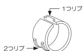
ハンドルにスペースをあて、その上にクランプをかぶせ、分解した部品を元通り仮組みします。
