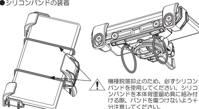
⚠ シリコンバンドを正しく装着することで、走行使用時の不意の機種脱落を抑止します。ホルダー本体裏側に設けられたバンド留め具に必ず装着し、ホルダーごと機種を巻き付け、確実に固定したうえでご使用ください。
