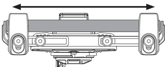
スライドアームを好みの位置に合わせてアーム固定ボルトを締めて固定します。
