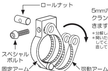
5mm六角レンチを使用して、組み立て済みのクランプを一旦分解し、可動アームを十分開きます。
