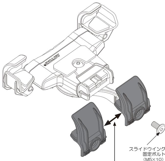
機種厚さが12mm以上の場合、3mm六角レンチを使用し、ウイングをHighタイプに交換してください。
