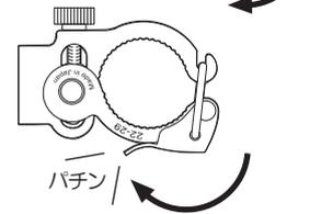
適度な抵抗感でレバーが「パチン」と音を立てて閉じ、クランプ全体が動かず固定できれば正しい状態です。「パチン」と音がしない、緩い(またはきつい)場合は、いったんレバーを起こしてクランプロックを解除し、スペシャルボルト(クイック用)を微調整して再度、やり直してください。
