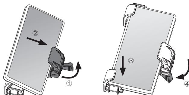
機種を差し込み、スライドウイングを押し込みながらスライドさせます。
