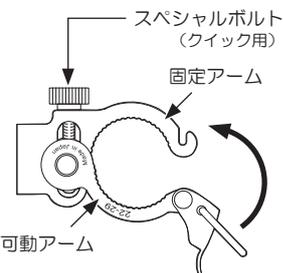
ハンドルにスペース(またはシート)を組み付け、その上に可動アームを十分に開いた状態のクランプをかぶせ、リングを固定アームのフックに掛けます。
