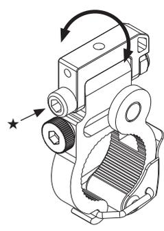
付属5mm六角レンチを使用し、上部★印の六角穴付きステンレスボルト(M6)を緩めることで、クランプの首振り角度を調整できます。調整後は車面にクランプした状態で★印の六角穴付きステンレスボルト(M6)を締め込み固定します。
