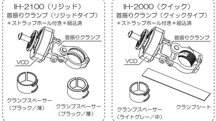
※VCD=バイブレーションコントロールデバイス(振動軽減装置)
