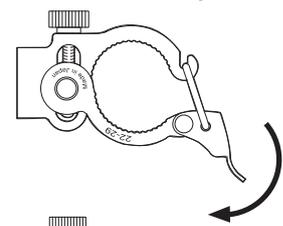
レバーを倒していき、ちょうど中間地点にきた時にぐっと重くなるように、スペシャルボルト(クイック用)を回して位置を調整します。
