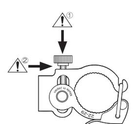
⚠ ① クランプを閉じた際に、スペシャルボルト(クイック用)とクランプの間に隙間が生じる、クランプ全体が動いてしまう場合は、クランプを再度分解し仮組みからやり直してください。
