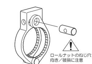
スペシャルボルトを固定アームのロールナットに組み付けます。まずは手締めで3回転ほどねじ込み、スペシャルボルトがまっすぐ無理なくねじ込めることを確認後、5mm六角レンチでしっかり締めて固定します。
