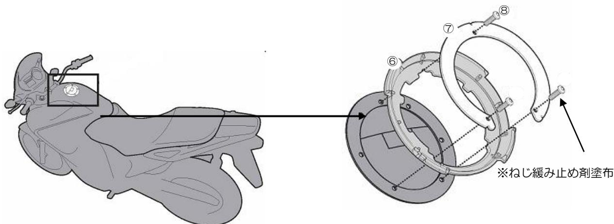
3. 手順 2 で取り付けした⑥フランチオスの位置と③バッグ本体のロック位置を合わせ、真上から押さえつければ取り付ける事ができます。※図 A 参照
