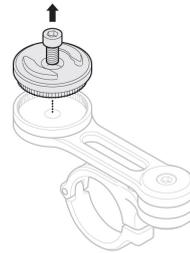
2. アーム使用の有無によりボルトを選択し、4mm六角レンチを使用して正しい長さのボルトをマウントに深く締め付けてください。※指定締め付トルク値は5Nmです。
