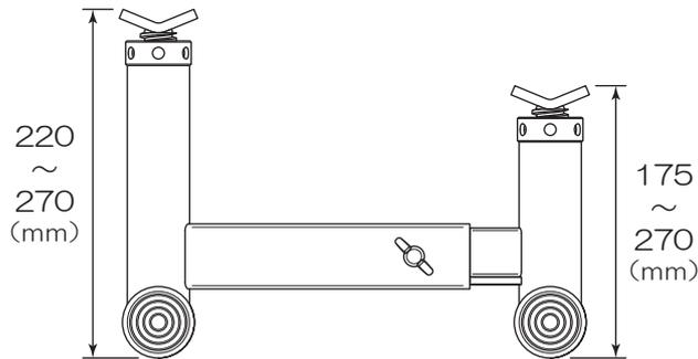
◇高さの『調整方法』 ※高さ調整はアジャストホルダーを回します
