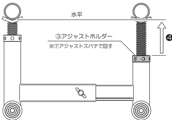
※車両は水平に持ち上げるように作業してください
