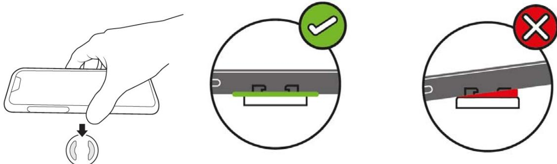
6. 90度回転させて取り付けします。マウントとの緩み外れがないことを確認してください。
