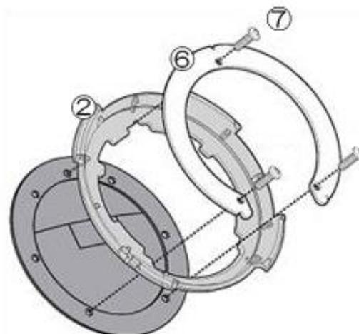
3. タンクバッグは車体に合わせてロック位置を変える事ができます。走行の妨げとならない位置にタンクバッグ裏のロック位置を調整します。位置合わせが終わったらタンクバッグのロック位置と手順 2 で取り付けしたフランジ奥斯位置を合わせ、真上から押さえつければ取り付けの事ができます。※図 A 参照
