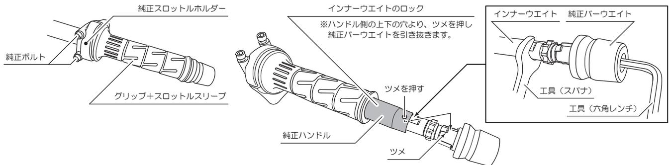
5. ①PZバーエンドへ、③キャップボルト挿し込み、②スペーサーの段付き部が、純正インナーウエイト側に向くようセットし、純正インナーウエイトへ仮止めし、純正ハンドルに挿し込み、スロットル操作に問題が無いことを確認します。
