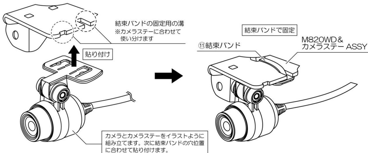
※イラストは M820WD を取り付ける場合のイメージイラストになります。M760D を取り付ける場合はイラストを参考にお取り付けください。
