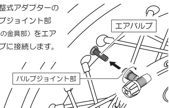
13. ⑧エアポンペを⑦調整式アダプターに右回転させながら取り付けます。
