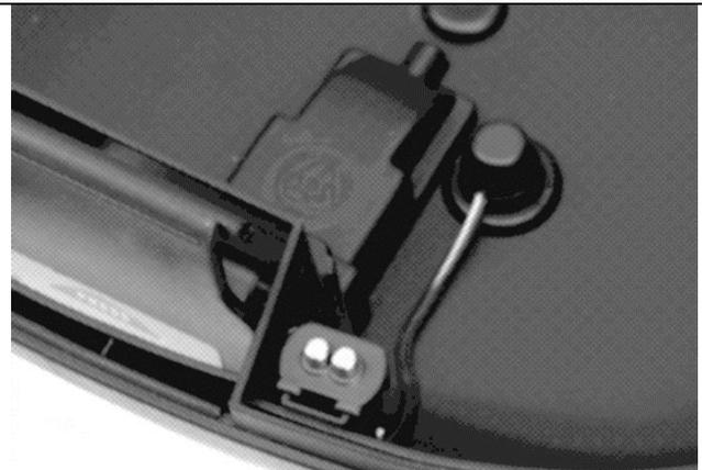
※. ③接点&配線セットの配線端子アセンブリ状態に不備がないことを事前に十分確認してください。不備がある場合は手順 9 を参考に、上下接点の配線端子の組み付けを正してください。作業後は、プッシュ式接点端子が単独で正しく上下可動することを必ず再確認してください。これら確認を怠ると点灯不良の原因となります。
