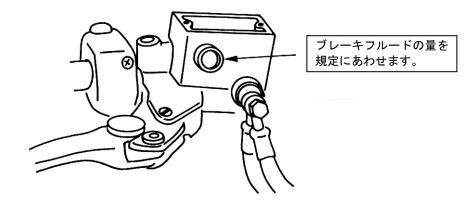
く新しいブレーキホース、キャリパー、マスターシリンダーに交換する場合には 3. の作業の次にブレーキフルードを注入して同様に作業を進めます。>
