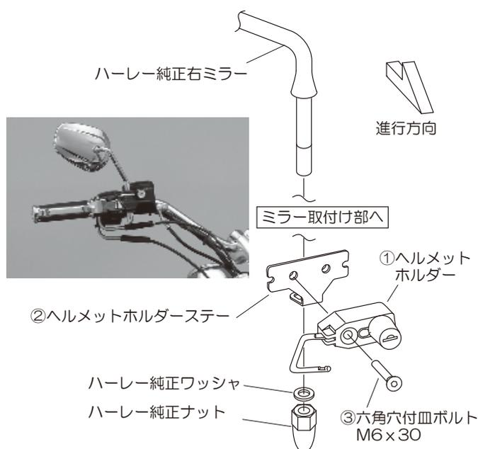
汎用タイプですがミラーの形状によってはミラーのアームと②ヘルメットホルダーステーが接触し装着できない場合があります。左右対称設計、車種によっては左右両方に装着できる場合があります。
