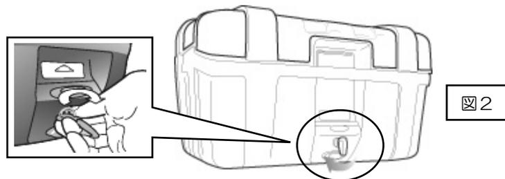
1-3. キーシリンダー上部にある解除ボタン（楕円型）を押すと、ケースのロックが解除されます。(図3参照)
