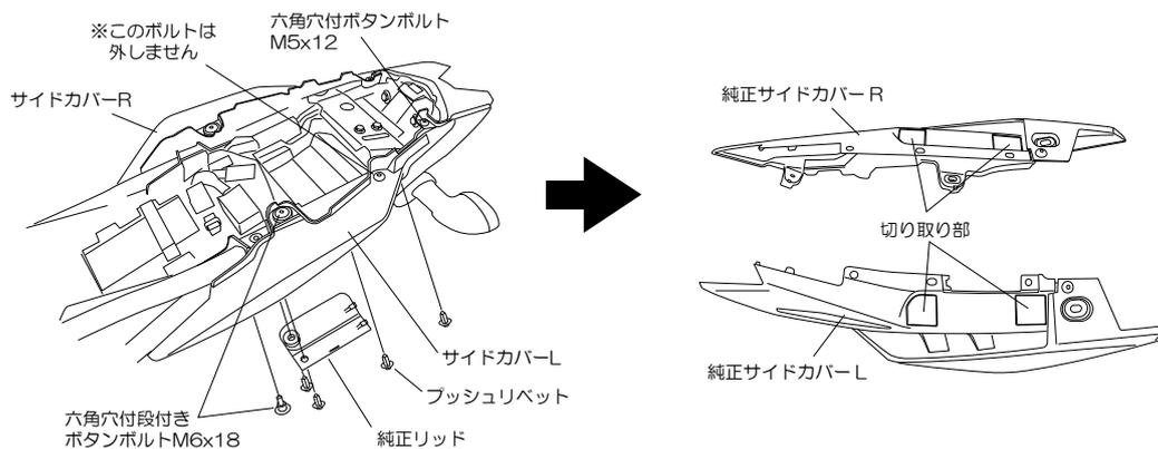
3. '14～' 16モデル 取り外した純正サイドカバーR (L) の裏側にある、けがきポイントの中心にポンチを打ち、コンパス等でΦ20の円をけがきます。
