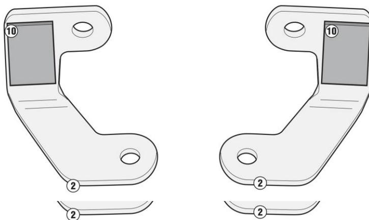
3.純正グラブバーとフレームの間に、②サポート 1(左右)と③サポート 2(左右)を⑤六角穴付きボルト(M8×30)と手順 1 で取り外した⑨純正ワッシャーを使い仮組みします。
