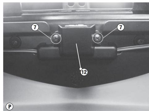
11. 作業後は、上蓋を何度か開け閉めし、トップシェルとボトムシェルに取り付けた接点が確実に接触することを十分確認してください。接触が不十分な場合は接点取り付け位置を微調整し、エポキシ接着剤やホットボンドなどを用いて接点が確実に接触する位置でしっかり固定してください。この位置調整が不十分だと、ケース走行使用時にランプ点灯不良（保証対象外）が発生する原因となります。
