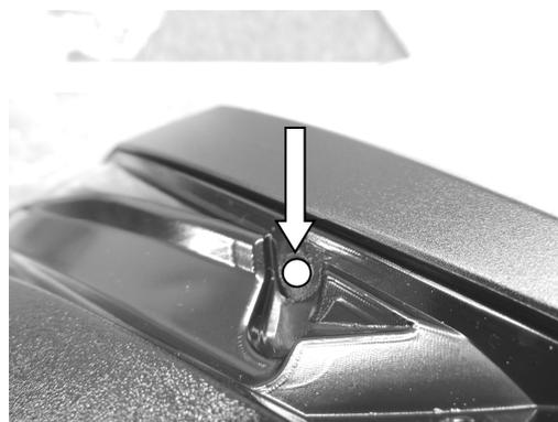
8. 図 M を参考に、手順 7 で加工した穴に配線を通し、リフレクター（左右）とメッキカバーを元通り組み付けます。
