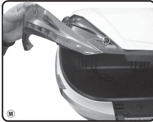
9. 図 N を参考に、配線の先端を④シェルコンタクト（上蓋用接点）に接続します。
