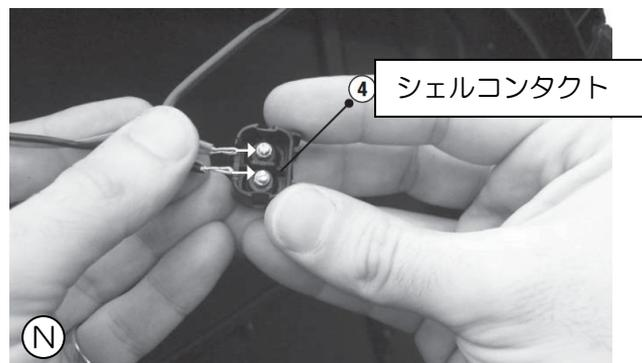
10. 図 O、P 参照に、手順 9 で接続した④シェルコンタクトを⑫トップシェルホルダーに差し込み、⑫トップシェルホルダーをケーストップシェルに組み付けます。
