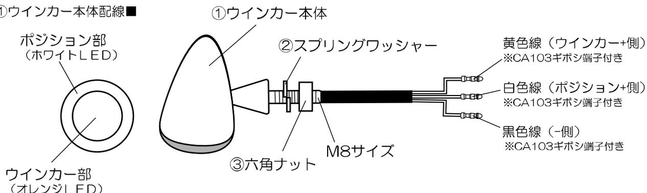
3-4. ①ウインカー本体の接続ハーネスは⑤CA103 端子です。組付けられていない場合はウインカーハーネスに取り付けしてください。純正のウインカーハーネスの端子形状を確認し、車体側の純正ウインカーハーネスを①ウインカー本体の接続ハーネス端子に合わせて加工してください。
