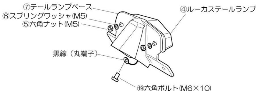
2-5. 2-3 で組付けたテールランプ ASSY と⑧ラバーを①フェンダー本体に⑱六角ボルト M6 × 12 (4本)、⑳平ワッシャ M6 (4個)、㉑スプリングワッシャー M6 (4個) にて取り付けます。
