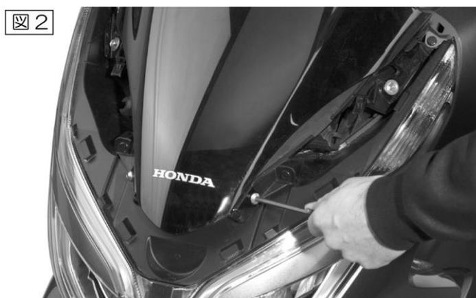
1-5. 図3を参考に純正スクリーンを固定しているワッシャー付きボルト(M6x12)を左右各1本取り外します。
