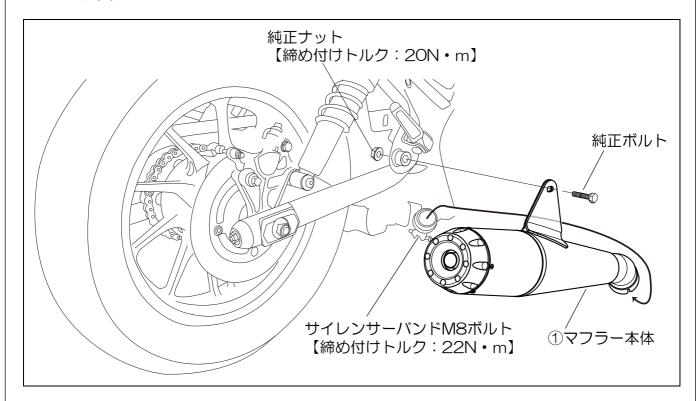
8. エンジンを始動させ、各取り付け部から排気漏れのないことを確認し、作業は完了です。
