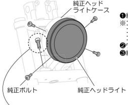
◆純正ヘッドライトを外しウインカーコネクタを外します。
