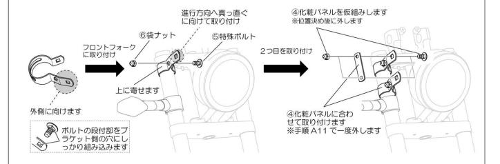
A10. 手順A03 で仮組みした純正ウインカーを⑦ウインカーステーと⑧六角穴付ボルト、⑨ワッシャ、⑩ナット、純正段付ボルト、純正袋ナットを使用して車両に取り付けます。
