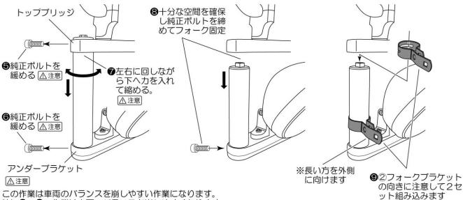
この作業は車両のバランスを崩しやすい作業になります。 特に**⑤**~**⑦**の作業は車両のバランスを崩しやすくなります。 転倒には十分に注意して作業を行なってください。
