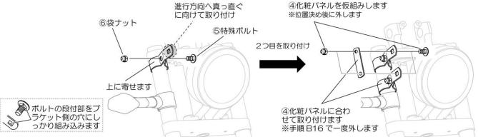
B15. 手順BO3 で仮組みした純正ウインカーを⑦ウインカーステーと⑧六角穴付ボルト、⑨ワッシャ、⑩ナット、純正段付ボルト、純正袋ナットを使用して車両に取り付けます。
